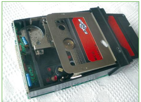
A floppy-meghajtó kinyitva, benne a kazetta. Jól látszik az író-olvasó fej és a miniaturizált mechanizmus
